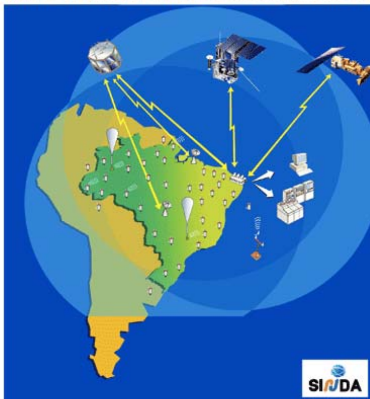
Sistema Brasileiro de Coleta de Dados, mostrando os círculos de visibilidade das estações de Culabá e de Alcântara.
